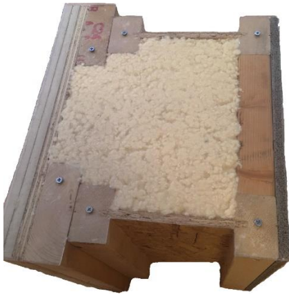
Ett block isolerat med Termoträ. REI120.
