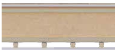
Vertikalsnitt lägenhetsskiljande bjälklagskonstruktion med brandklass REI60.
