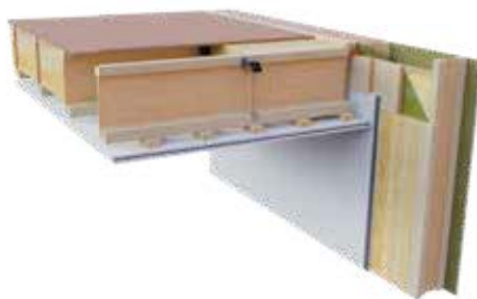
Vertikalsnitt lägenhetsskiljande bjälklagskonstruktion med brandklass REI60.
