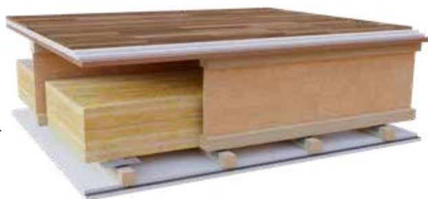
En typisk lägenhetsskiljande bjälklagskonstruktion med brandklass REI60.
